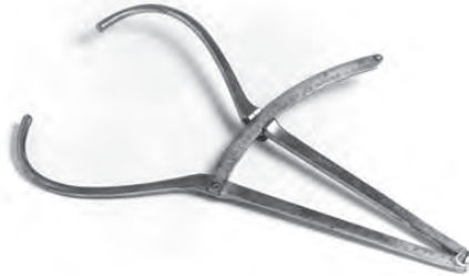
Fig. 12 – Craneómetro de Infocefalia. Diseñado por el Ingeniero David Verde, aporta importantes modificaciones al clásico cefalómetro de Bertillon. No solo por sus dimensiones, mas fácilmente manejable, y por su bajo coste, sino por la aplicación de conceptos matemáticos que corrigen la medición de fragmentos de circunferencia, como hace el Bertillon, convirtiéndolos en medidas lineales equiparándolas a las obtenidas sobre fotografías, recurso habitual en neurocirugía, transformándolo en una herramienta indispensable para el seguimiento en la Atención Primaria.
